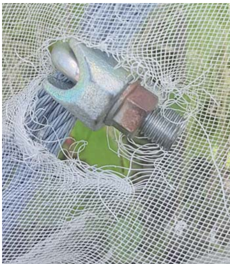
Abb. 7: Seilklemmen und Plaketten verursachen häufig Scheuerstellen und Löcher in den Netzen
